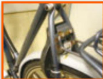
Lijkt op een mooi AXA SL7 slot. Maar de sticker geeft aan dat het een chipslot moet zijn. Gelet op de code boven op het slot is het geen chipslot. Het moet een nummer van 10 of 15 cijfers zijn.
