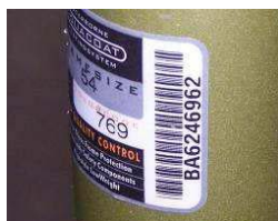
RAI standaard framenummer aangebracht op frame
